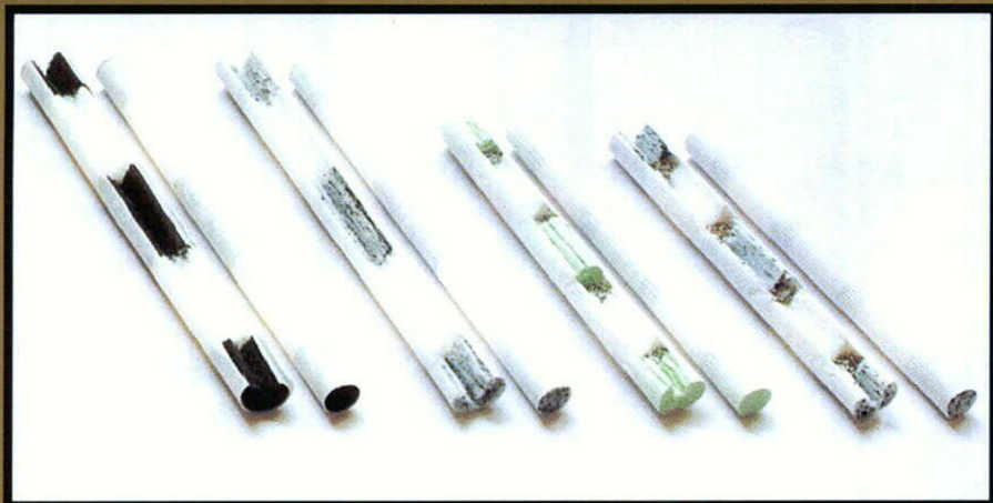
다양한 필터의 종류. 최근 사용되는 대부분의 필터는 셀룰로오스 아세테이트를 기본으로 여기에 활성탄 등을 배치시키고 있다.
